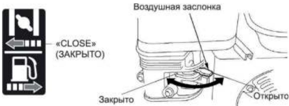
2. Передвиньте рычаг заслонки в положение CLOSE (закрыто).
